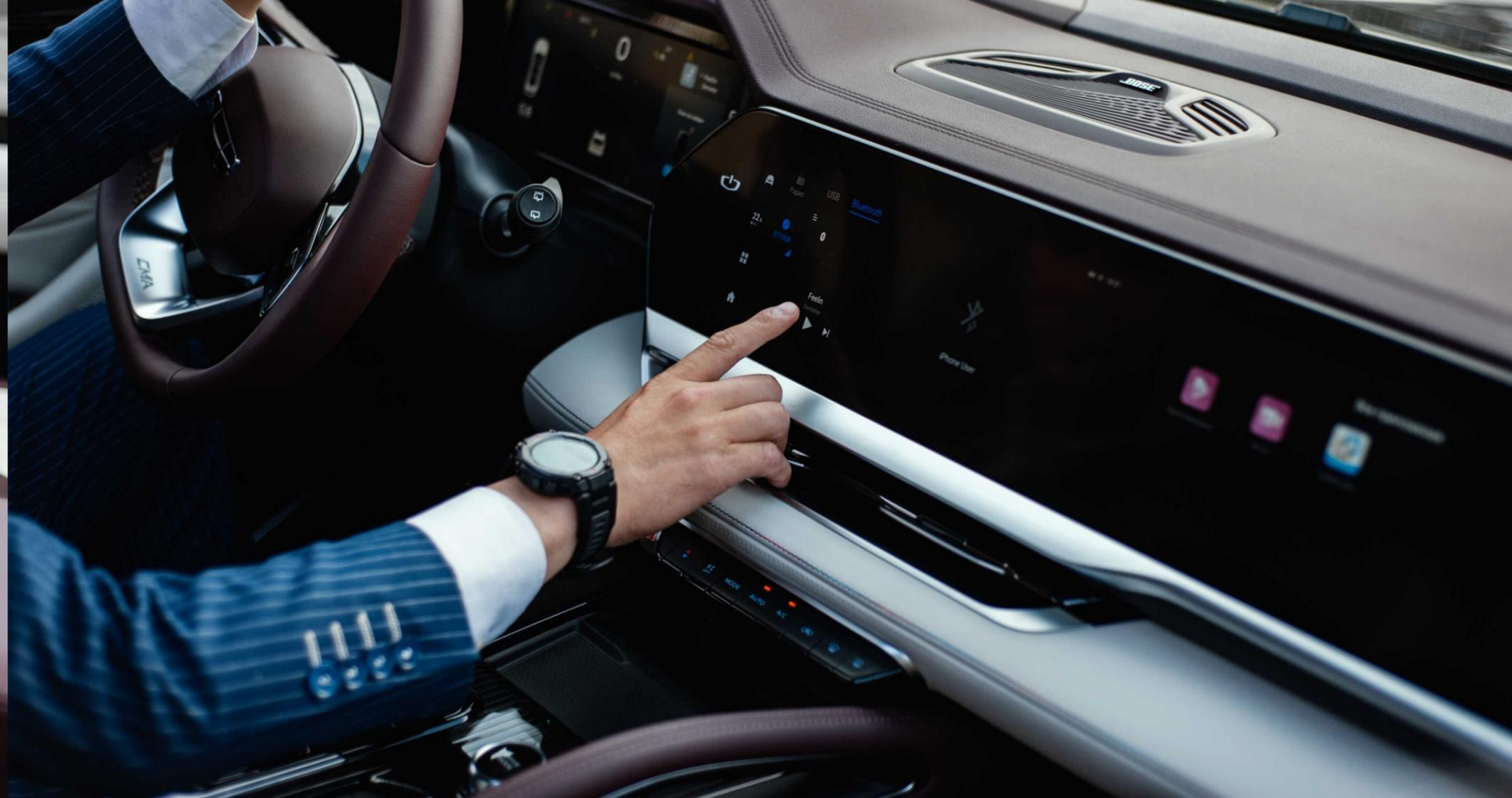
Впечатляющая размерами панорамная ЖК-панель. Вместе с электронной комбинацией приборов и дисплеями мультимедиа она образует три отдельных экрана, которые работают вместе, так что вам не придется переключать режимы
