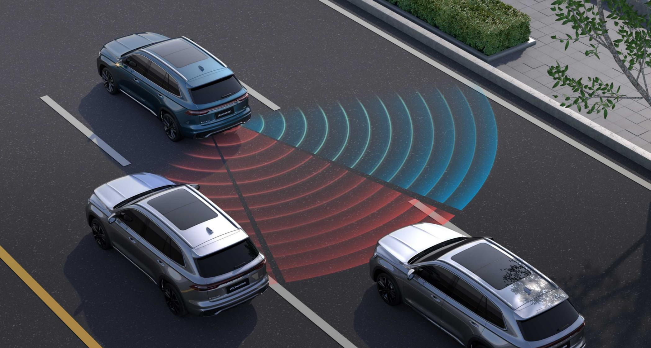
Автомобиль предупредит вас об автомобиле в слепой зоне и об опасности при открытии дверей,
